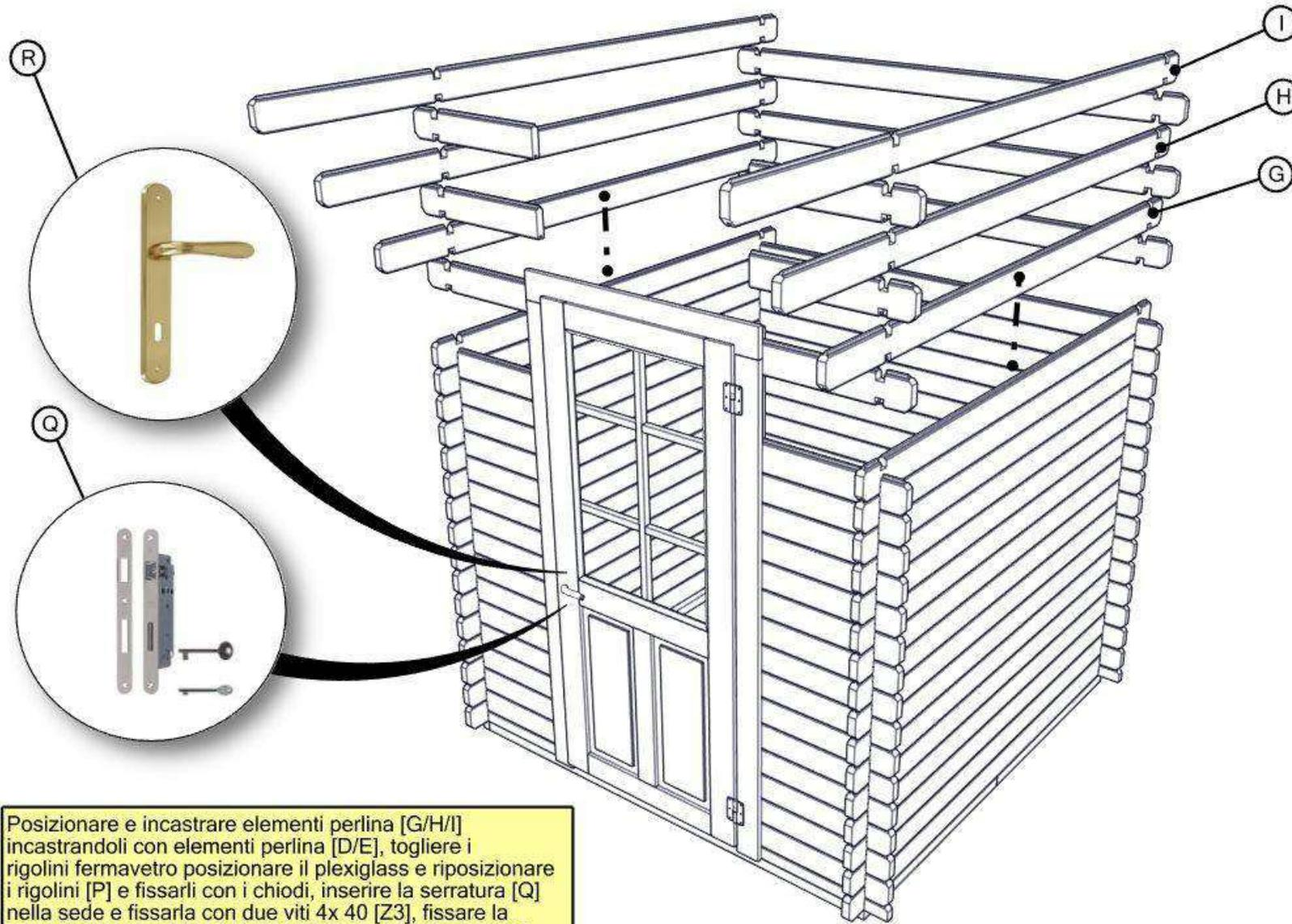
Posizionare e incastrare elementi perlina [G/H/I] incastrandoli con elementi perlina [D/E], togliere i rigolini fermavetro posizionare il plexiglass e riposizionare i rigolini [P] e fissarli con i chiodi, inserire la serratura [Q] nella sede e fissarla con due viti 4x 40 [Z3], fissare la maniglia [R] con 6 viti 3,5 x 20 e fissare il contrasto [S] serratura sul montante porta fissandolo con 2 viti 4x 40 [Z3]
