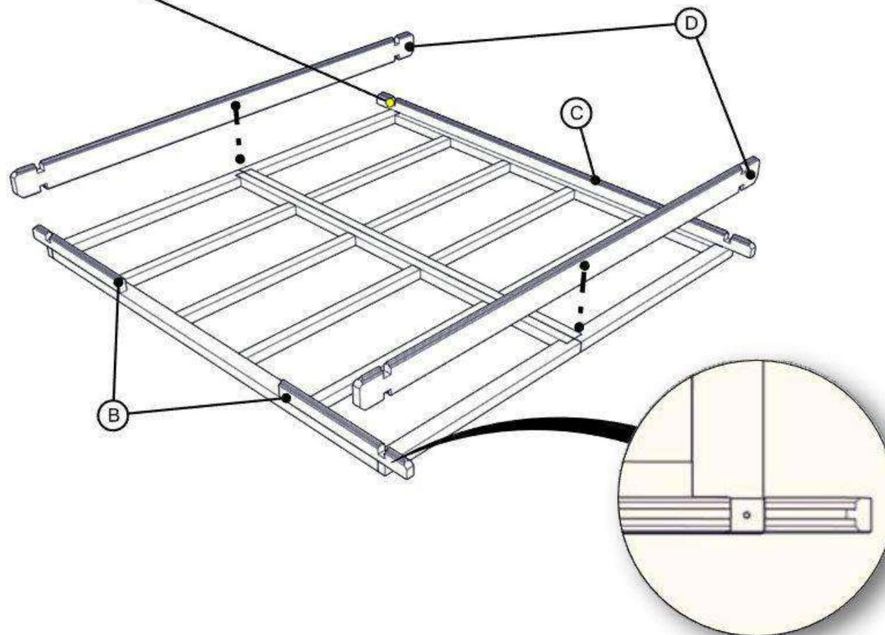
Posizionare e incastrare elementi perlina [E/D] per 6 strati iniziando con l'elemento perlina frontale [E] a DX poi con l'elemento perlina [D] laterale, posteriore, laterale ed infine l'elemento frontale SX [E]
