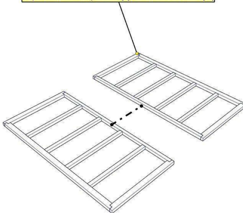
Posizionare elementi perline [B/C] fissandoli al telaio pavimento [A] con 4 viti 4,50x60 [Z1]
